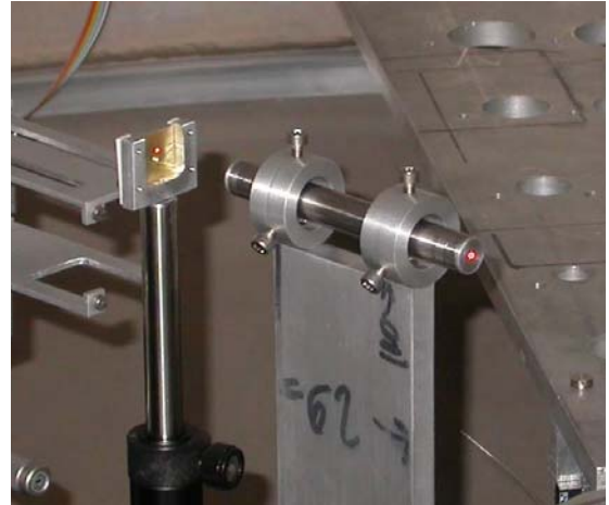
Figura 4.19: Il fascio laser attraversa le estremità del precollimatore
