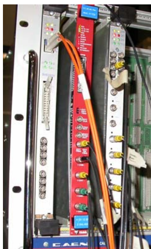
Figura 5.8: Gli ADC inseriti nel crate VME (bus industriale per moduli a microprocessore)
