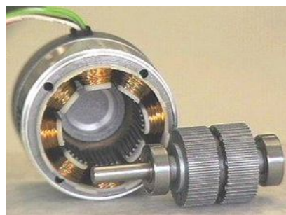
Figura 1-3: Struttura di un motorino Stepper
