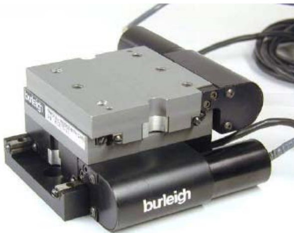
Figura 1-6: Due attuatori burleigh TSE-150 montati su piastre in configurazione X-Y
