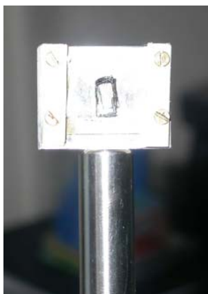
Figura 4.12: Il collimatore finale montato sul supporto
