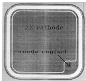
Figura 2-2: Primo prototipo. Regione attiva 4x4 \text{mm}^2 [4]
