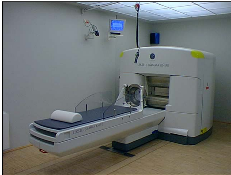
Figura 3.2: Foto di una unità Gamma Knife® modello C, in cui è visibile il lettino per il paziente, il casco contenente i collimatori e la struttura di copertura delle sorgenti radioattive.
