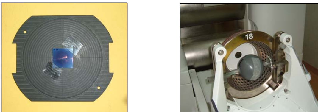
Figura 5.2: Foto della procedura seguita per la calibrazione dei film HS. Sulla sinistra è visibile uno dei film usati per la calibrazione, fissato sul piatto da inserire nel fantoccio. Sulla destra vi è una foto che ritrae l'apparato pochi istanti prima che il sistema di posizionamento conduca il fantoccio all'interno della struttura contenente le sorgenti.
