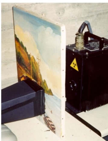
Fig. 3.18: esempio di posizionamento di un dipinto nella tecnica on-line
