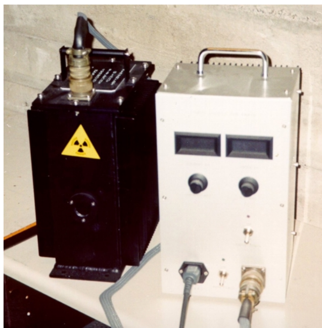
Fig. 2.5: foto del tubo con relativo alimentatore
