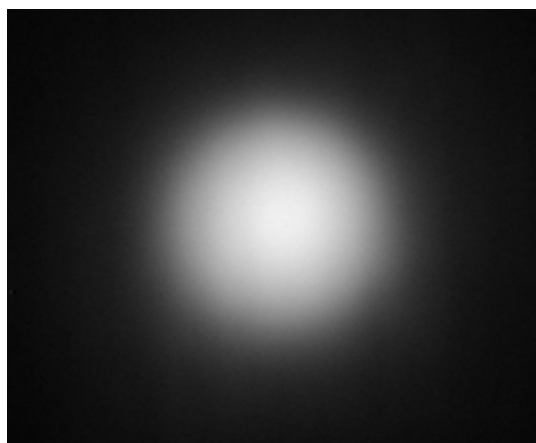
Figura 1.5 -Immagine ripresa con LEBI usando una sorgente ^{90}\text{Sr} 31 MBq non collimata.
