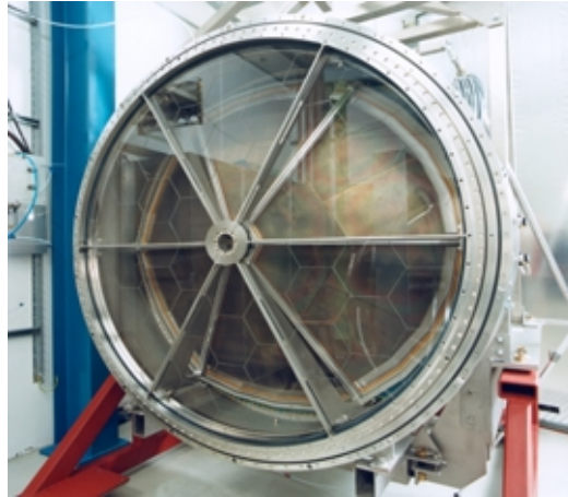
Figura 3.4: Radiatore del rivelatore a luce Cherenkov (RICH).
