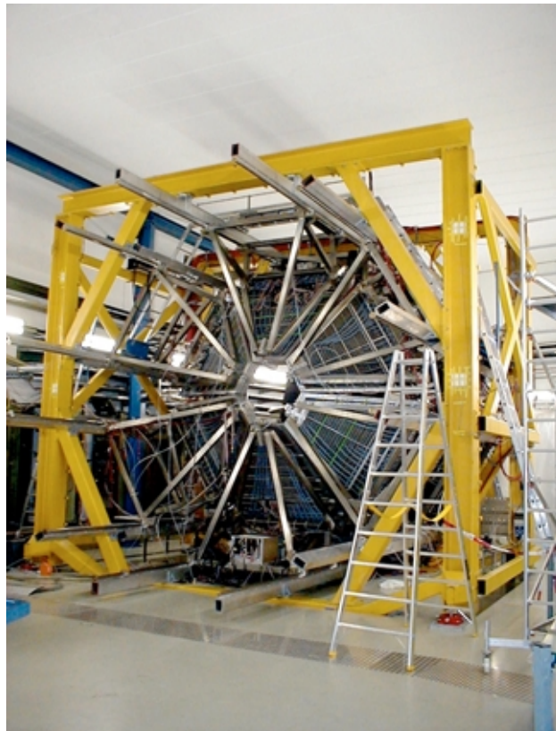
Figura 3.1: Veduta di H.A.D.E.S.. E' possibile notare la suddivisione di tutta la struttura in 6 settori uguali attorno alla direzione del fascio.
