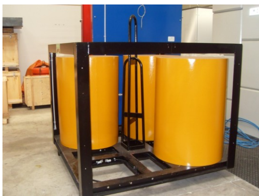
Fig 4.13 Struttura di ferro più le sagome dei fusti (i fusti sono vuoti)
