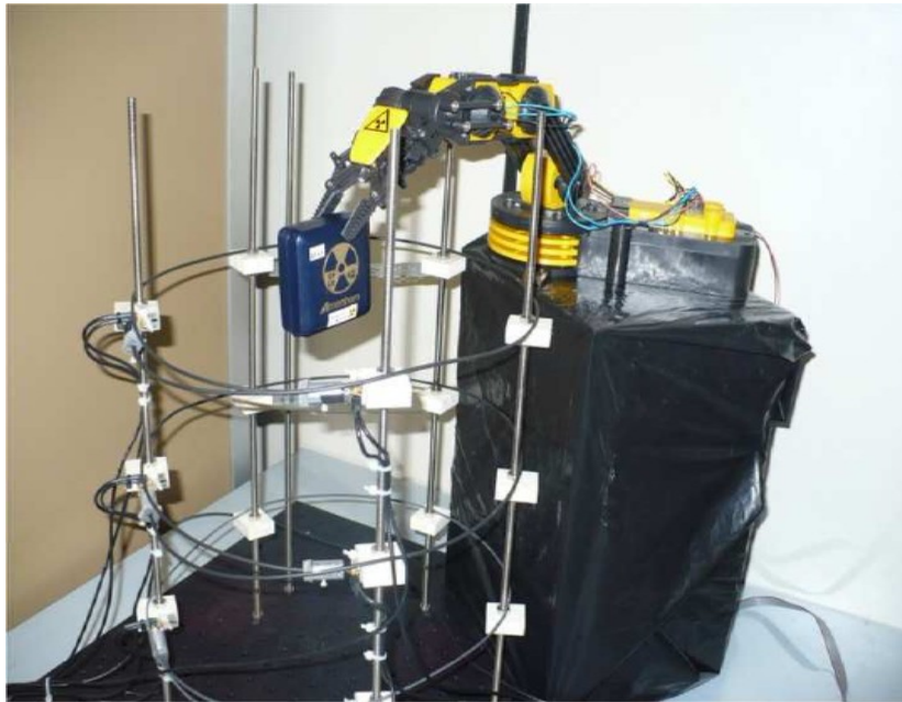
Fig 2.8 Prova di posizionamento della sorgente tramite il braccio robotico
