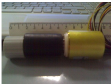
Fig. 6.3 Rivelatore a scintillazione montato sul braccio robotico
