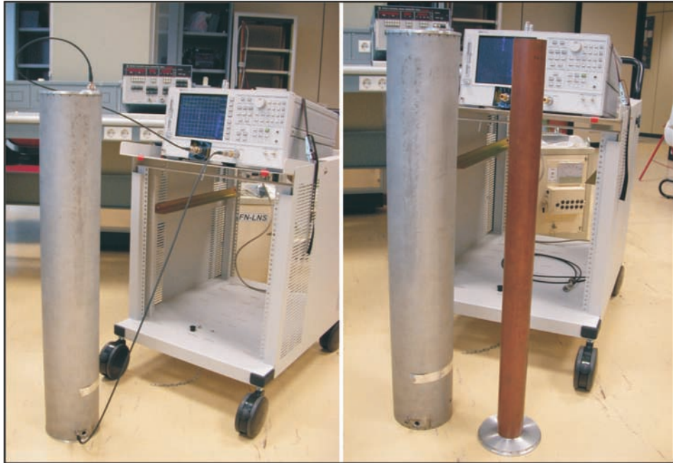
Figura 5.2: Foto della cavità a mezz'onda. La foto di sinistra si riferisce alla fase di misura, quella di destra mostra la cavità aperta ed è visibile il coassiale interno.
