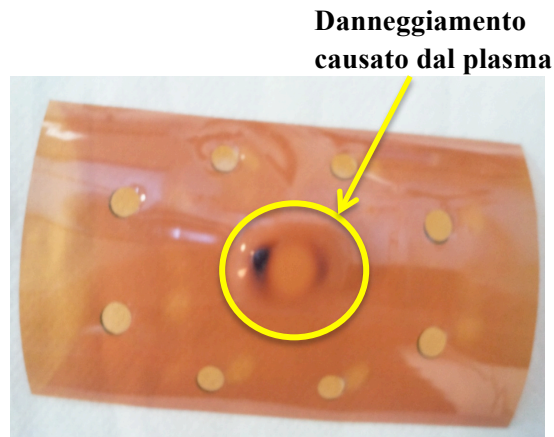
Figura 5-14: finestra delle microonde (foglio di Kapton di spessore 0,5 \mu m)
