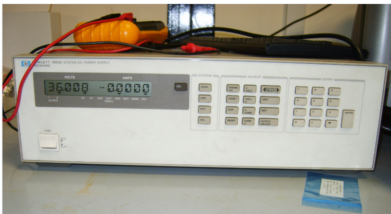
Fig. 14 – Immagine frontale dell'alimentatore ad alto voltaggio per il funzionamento del SiPM
