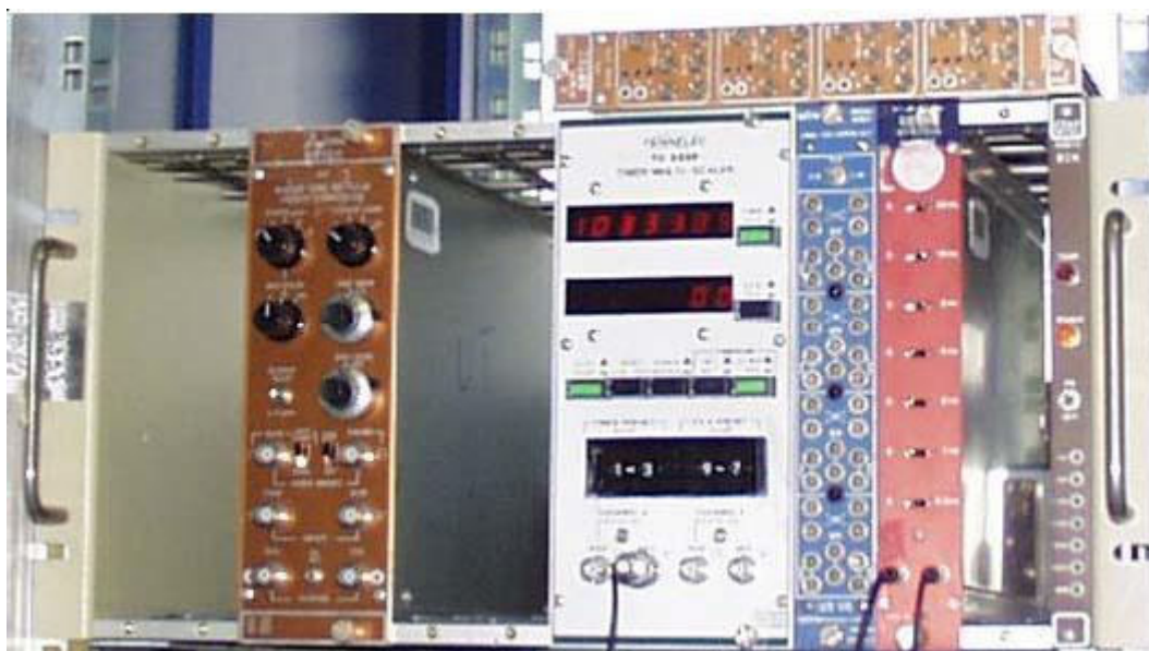
Fig. 3.1 : Crate in cui sono inseriti moduli NIM, di diversa misura e funzionalità.
