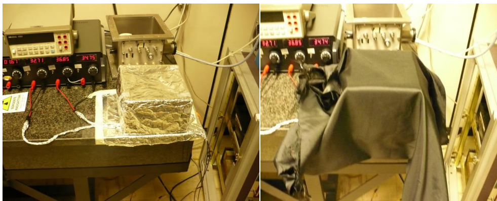
Figura 7.6: Setup sperimentale per la schermatura elettromagnetica (sinistra) e ottica (destra).
