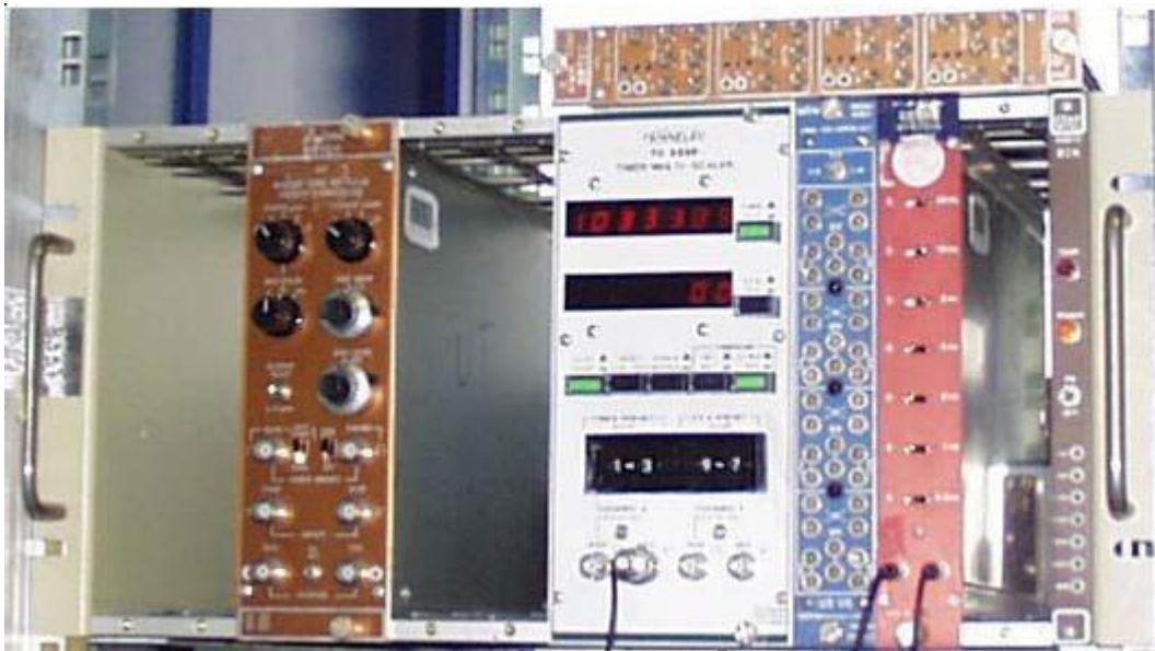
Figura 4.16 : raccoglitore in cui sono inseriti moduli NIM di diversa funzionalità.
