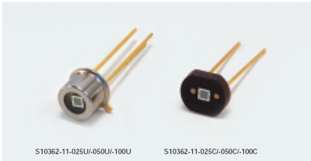
Figura 4.1: in questa figura viene riportata l'immagine dei SiPM utilizzati per le misure sperimentali.
