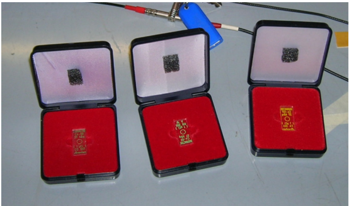
Figura 4.2: vengono mostrate le sorgenti di ^{137}\text{Cs} e ^{60}\text{Co} utilizzate.
