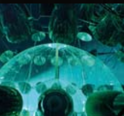
Rivelatore di Neutrini solari nei laboratori Nazionali INFN del Gran Sasso
