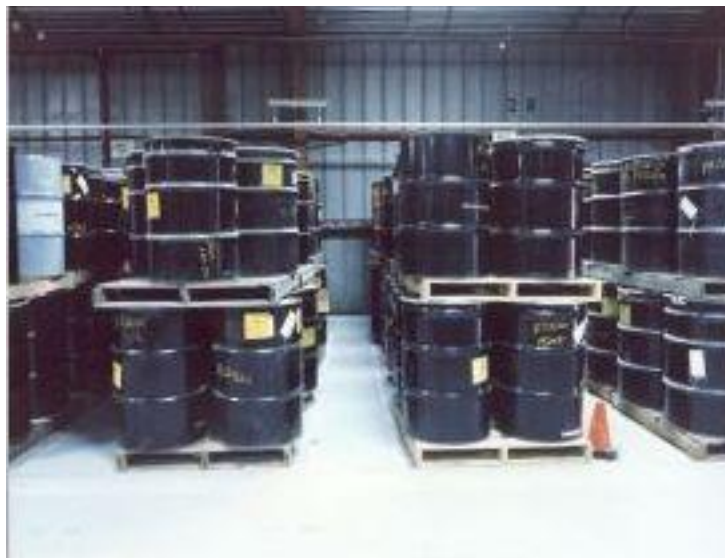
Figura 2. Esempio di deposito di fusti contenenti materiale radioattivo.
