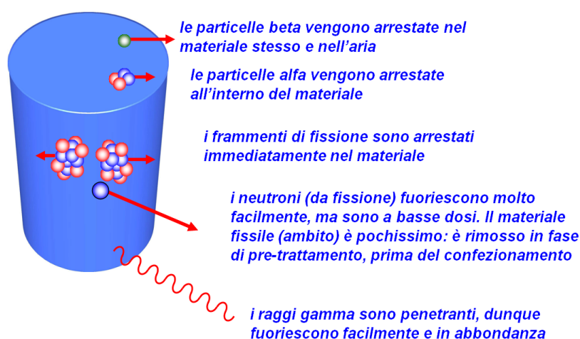
Figura 3. Schema delle radiazioni e del loro livello di penetrazione, in un comune fusto di rifiuti radioattivi.
