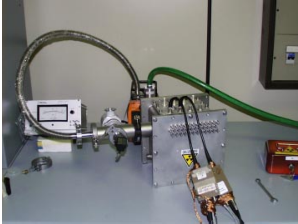
Figura 5-3: Camera da vuoto e pompa rotativa. All'interno è sistemato il rivelatore monolitico da cui si dipartono i cavi che lo collegano ai due preamplificatori.
