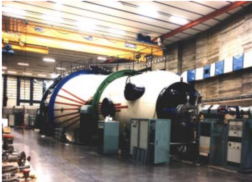
Figura 1-4: L'acceleratore Tandem da 15 MV. La tank esterna, necessaria per sostenere la struttura elettrostatica e contenere il gas di isolamento SF_6 a 7 bar, è lunga 25 metri e pesa circa 130 tonnellate
