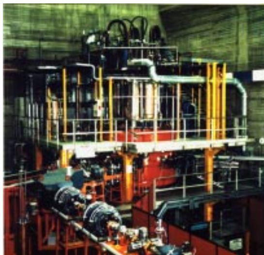
Figura 1-5: Il Ciclotrone Superconduttore con una parte della linea di estrazione dei fasci di ioni.
