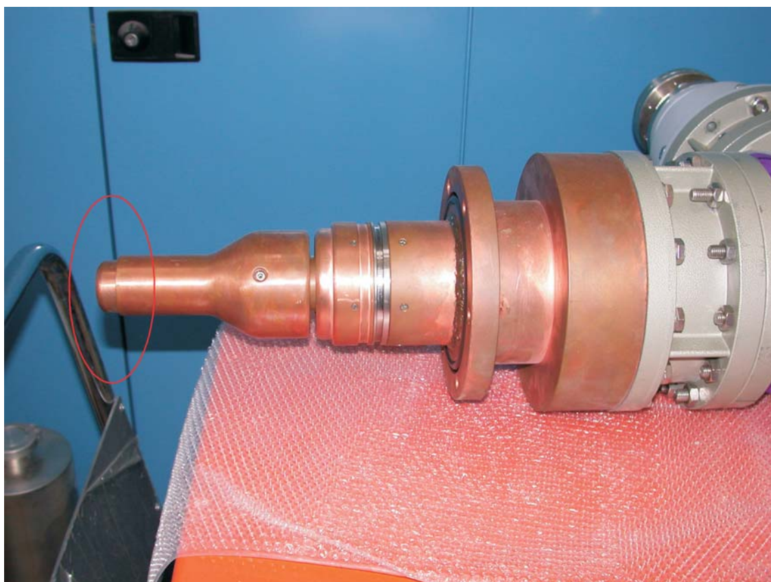
Figura 2.16: Particolare del coupler realizzato. Si noti la parte mobile, cerchiata in rosso
