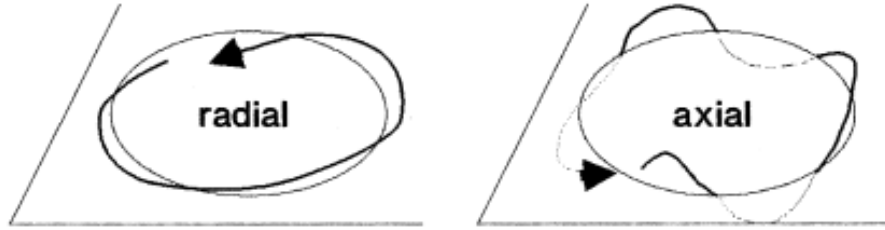
Figura 2.2: Rappresentazione schematica delle oscillazioni di betatrone attorno a un'orbita circolare di equilibrio.
