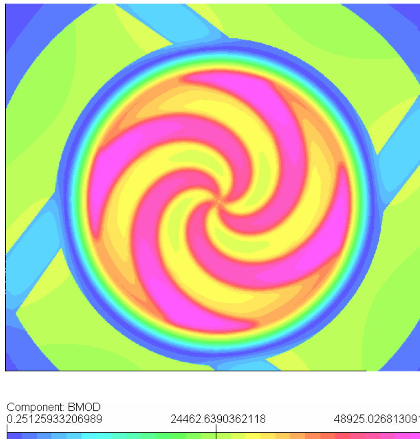
Figura 6 Visualizzazione del campo magnetico sul piano mediano.
