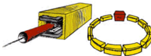
Figura Schema semplificato di un sincrotrone.
