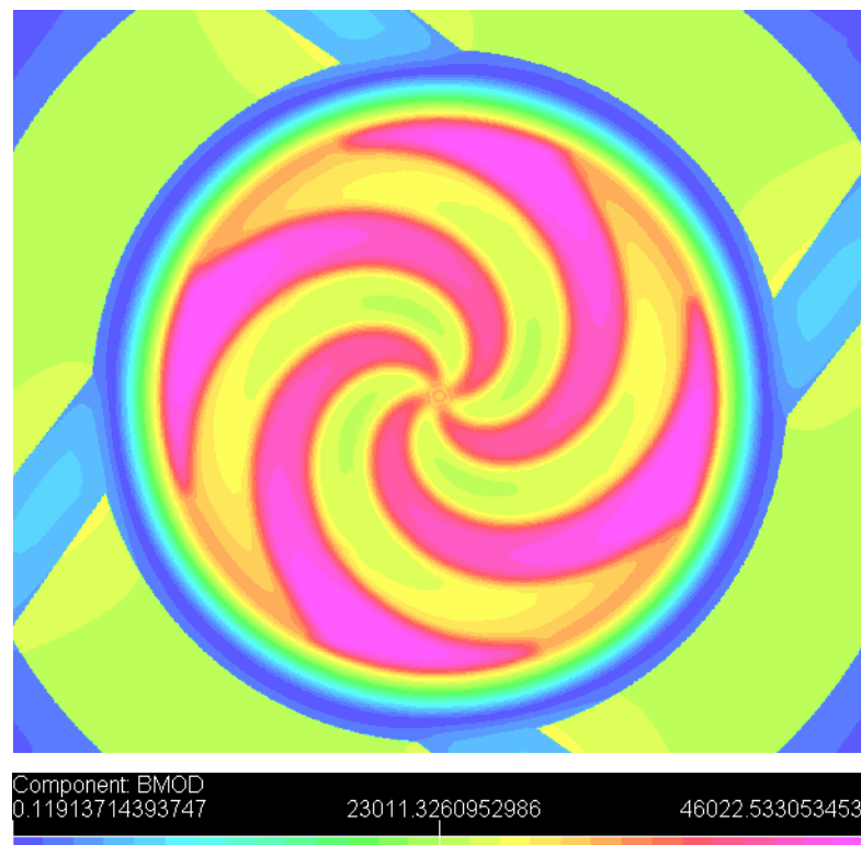
Figura 13 Campo magnetico simulato, calcolato nel piano mediano.
